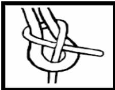
Der **Schotenstich** dient zur Verbindung zweier ungleich starker Leinen. Wird der **Schotenstich mit Aufziehschlaufe** gestochen, kann er bei Belastung oder bei Gefahr durch Ziehen an der Aufziehschlaufe sofort gelöst werden.
