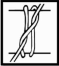
Der **Mastwurf** ist der wichtigste Knoten bei der Feuerwehr. Er dient insbesondere zum Befestigen von Gegenständen, wie der Ventilleine beim Einsatz einer Saugleitung oder zur Sicherung des Auszugseiles der Schiebleiter. Außerdem wird er zum Hochziehen von Gegenständen eingesetzt. Der **Mastwurf** kann gelegt und gestochen werden.
